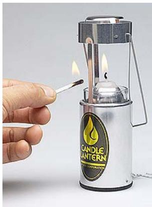
Hierbei handelt es sich um kleine, meist zusammenschiebbare Laternen, in die man je nach Modell Teelichter oder Spezialkerzen einsetzen kann. Diese Kerzen werden automatisch durch eine Feder nachgeschoben. Die Flamme selbst ist durch eine Glasröhre vor Wind geschützt. Sie wiegen mit Kerze allerdings 200 g. Eine Kerze hält etwa 8 Stunden. Die Kerze gibt auch Wärme ab, eine Schneehöhle könnte so auch ein wenig beheizt werden. Wenn man das Gewicht nicht scheut, eine gemütliche Sache.
