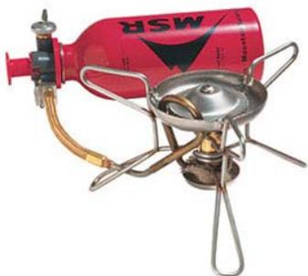
Hiervon gibt es eine Vielzahl von Modellen. Alle haben einen Tank, in dem Benzin mittels einer Pumpe unter Druck gesetzt wird, dieses vergast und gelangt dann zu einem Brenner. Über dem ist eine Gestell, auf das die Kochgefäße gestellt werden.
